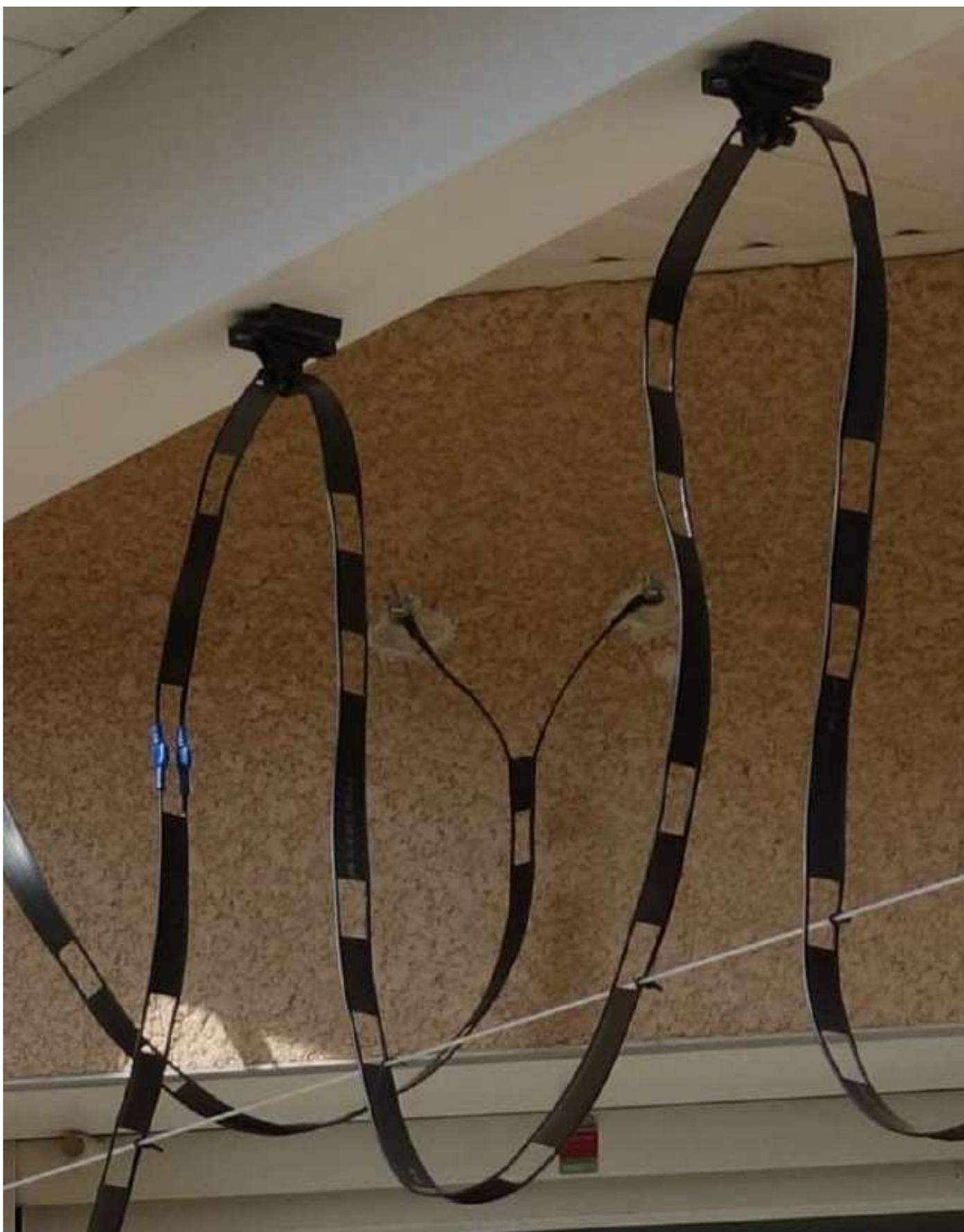
*Détail des cosses Faston mâle/femelle plates permettant d'ajuster la longueur, les protéger (voir milieu gauche) et les points d'entrée du Twin-lead vers l'intérieur du Shack tout au fond au centre de l'image.*
